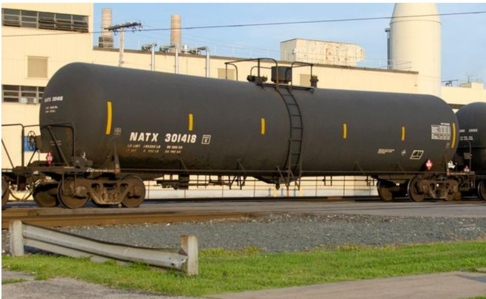
Un wagon-réservoir DOT-111 utilisé pour le transport du pétrole brut, de l'éthanol et d'autres matières dangereuses
