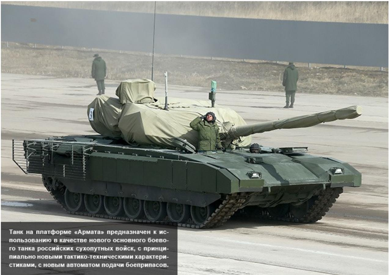
Танк на платформе «Армата» предназначен к использованию в качестве нового основного боевого танка российских сухопутных войск, с принципиально новыми тактико-техническими характеристиками, с новым автоматом подачи боеприпасов.
