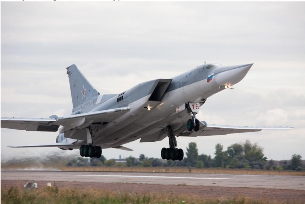
L'avion a un rayon d'action de 4.000 km et porte 24 tonnes de bombes ou raquettes. Tu-22M3 peut être armé de 10 raquettes de croisière : 6 x Kh-15 (vitesse Mach 5, visée 250 km) dans le lanceur rotatif caréné à l'intérieur du fuselage, et 4 x Kh-22/27 (vitesse Mach 4, visée 500 km) ou bien Kh-55 (visée 2.000 km) sous le fuselage ou sur les piliers des ailes. Le dispositif russe de défense de la péninsule de la Crimée inclura à partir de 2015 des raquettes Iskander-M (rayon d'action 500 km).
